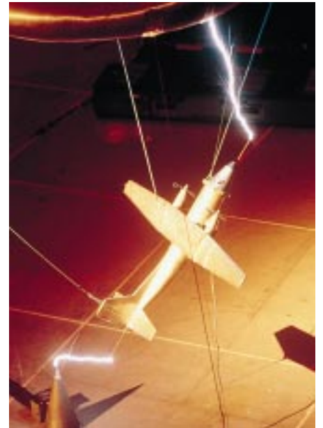
Déclenchement d'une décharge à partir d'une structure à potentiel flottant Maquette d'Avion Transall au 1/10 (Photo ONERA/EDF)
