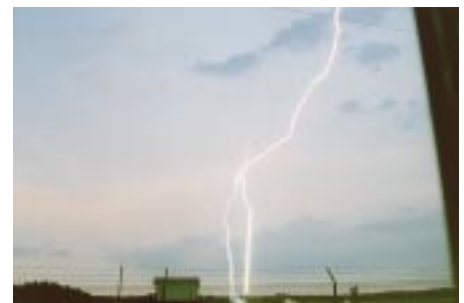
Déclenchement d'un coup de foudre par le CEA/CENG Collaboration EDF/ONERA (Photo EDF)
