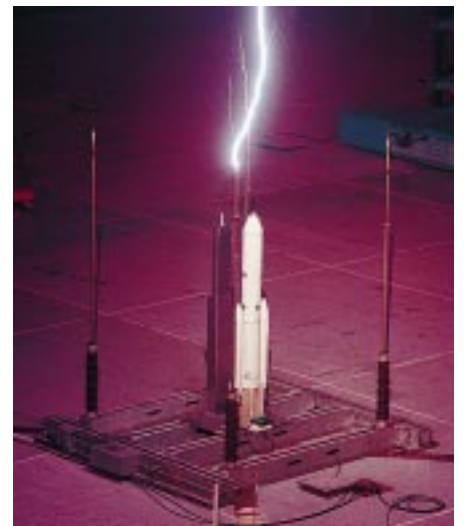
Etude d'un point d'impact d'une décharge sur une structure au sol. (Photo CNES/ONERA/EDF)
