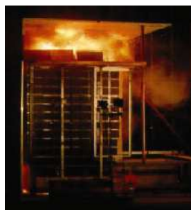
Essai d'arc interne
