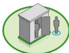
poste aménagé à couloir de manœuvre
