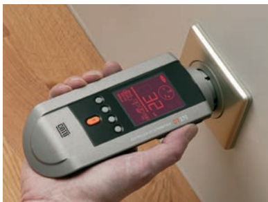
Contrôle de différentiels sur prise 2P+T avec le Catex™ NG (Réf. DT-170).
