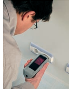
Mesure de la résistance de terre sur prise 2P+T avec le Cathom™ NG (Réf. DT-300).
