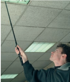
Contrôle de continuité sur plafonnier avec perchette de contact (Réf. M-951143) raccordée au Cathom™ NG.
